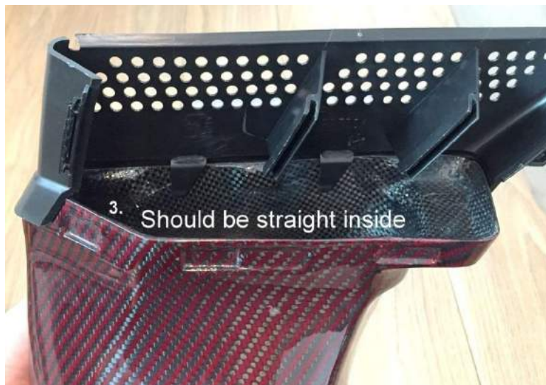
37. Nehmen Sie die linke Carbonführung und die linke serienmäßige Plastikführung. Drücken Sie die Carbonführung in die Plastikführung wie auf dem Bild.
