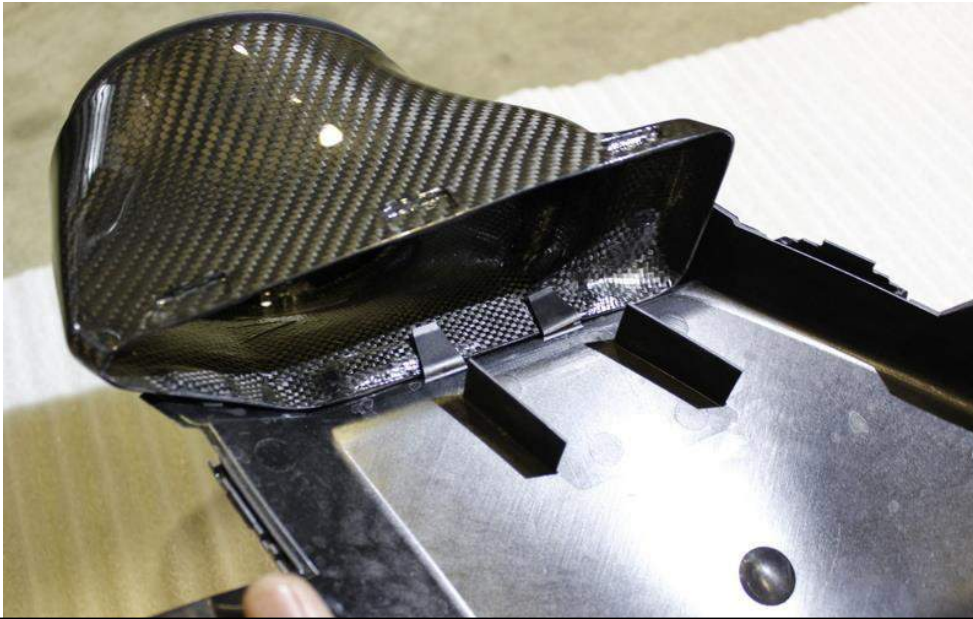
37. Nehmen Sie die linke Carbonführung und die linke serienmäßige Plastikführung. Drücken Sie die Carbonführung in die Plastikführung wie auf dem Bild.
