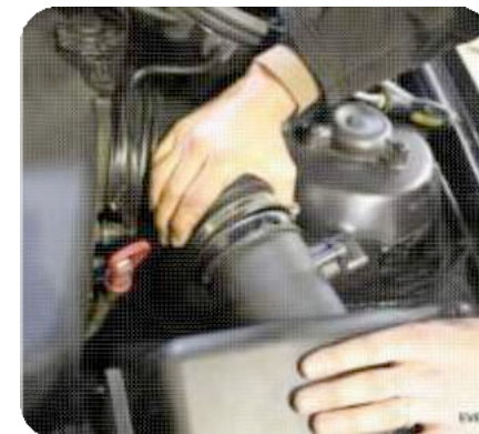
4. Schelle lösen und Luftfilterkasten entfernen.
