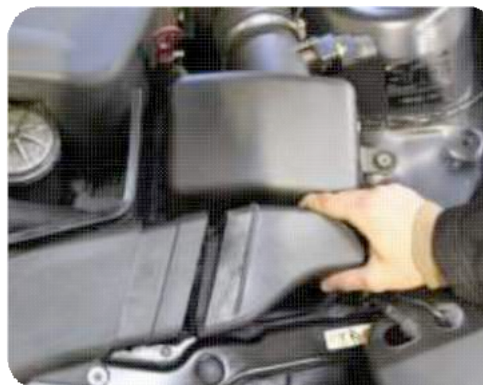
3. Die erweiterte Luftführung entfernen.
