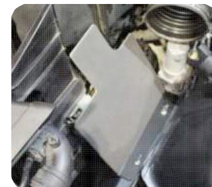
8. Hitzeschild installieren. Hierfür die beiden beiliegenden 10 mm Muttern nutzen.
