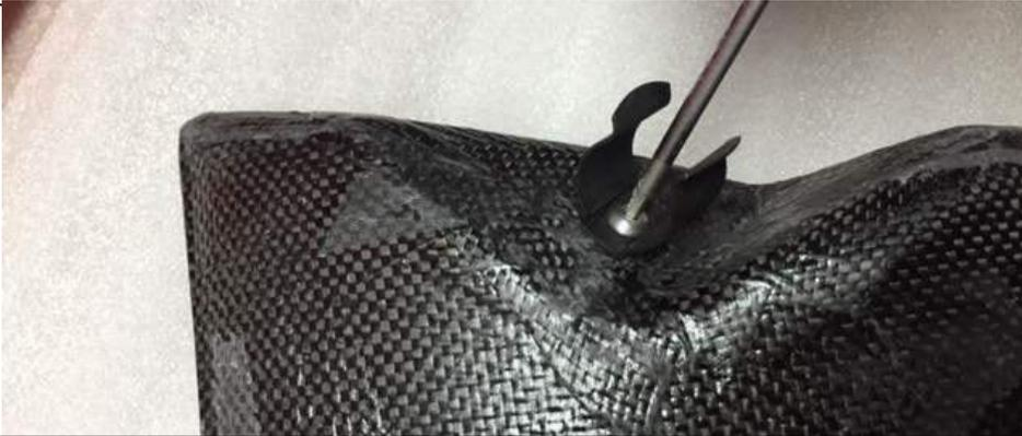
25. Für den M235i / M135i nehmen Sie den Metallklips und fixieren Sie ihn mit der silbernen M5 Schraube auf der Rückseite des Carbon Scoops. Schrauben Sie die Schraube hinein.
