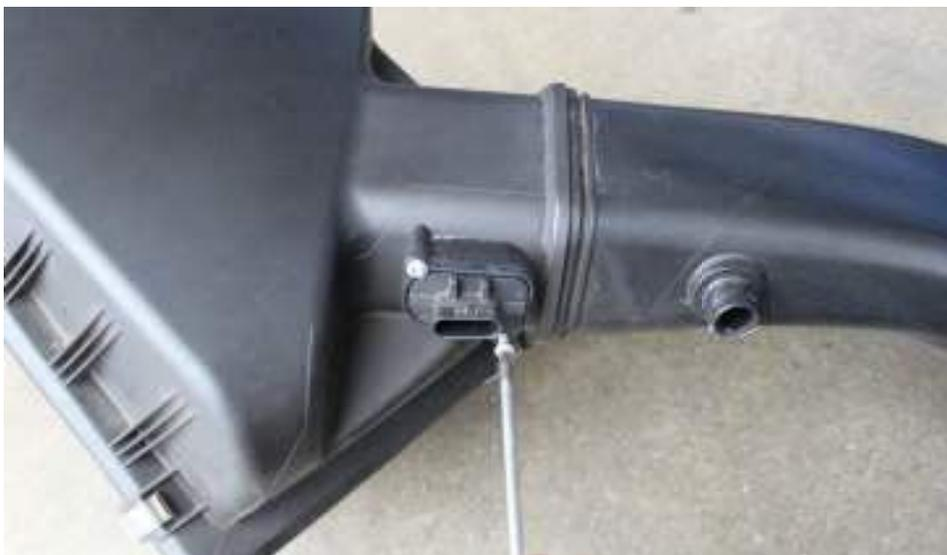
13. Entfernen Sie den Sensor des Luftmassenmessers von der Serienbox. Lösen Sie dafür die 2 Torx Schrauben und ziehen Sie den Sensor hinaus. Behandeln Sie den Sensor mit Vorsicht!
