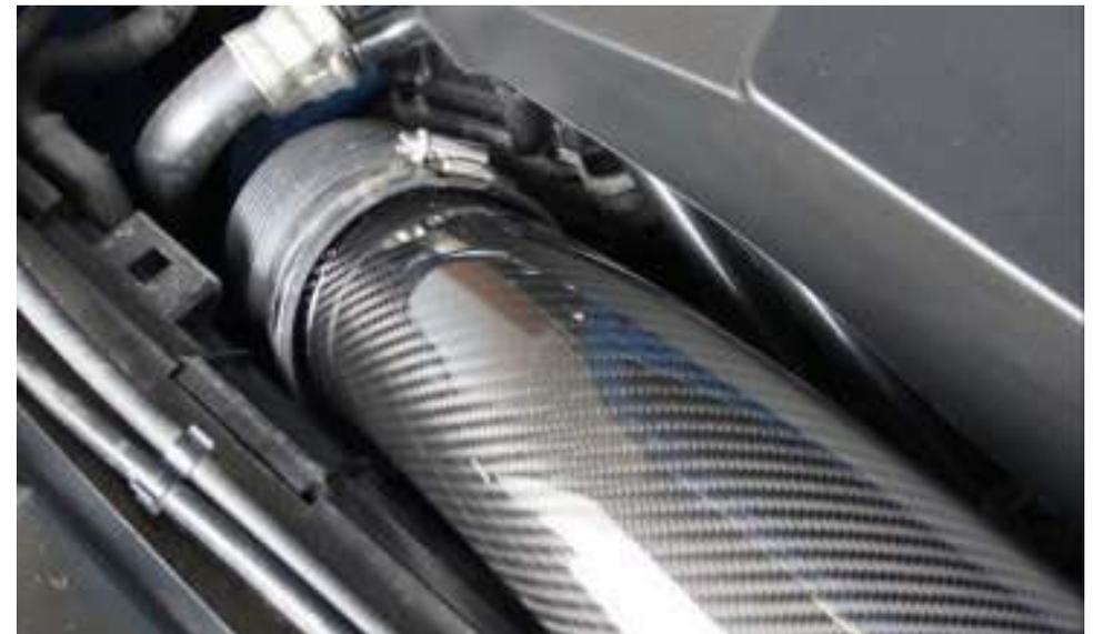
20. Drücken Sie das Carbon Rohr komplett in den flexiblen Zulaufschlauch – stellen Sie sicher, dass der Schlauch das Carbon Rohr komplett umschließt und ziehen Sie die Klammern fest.
