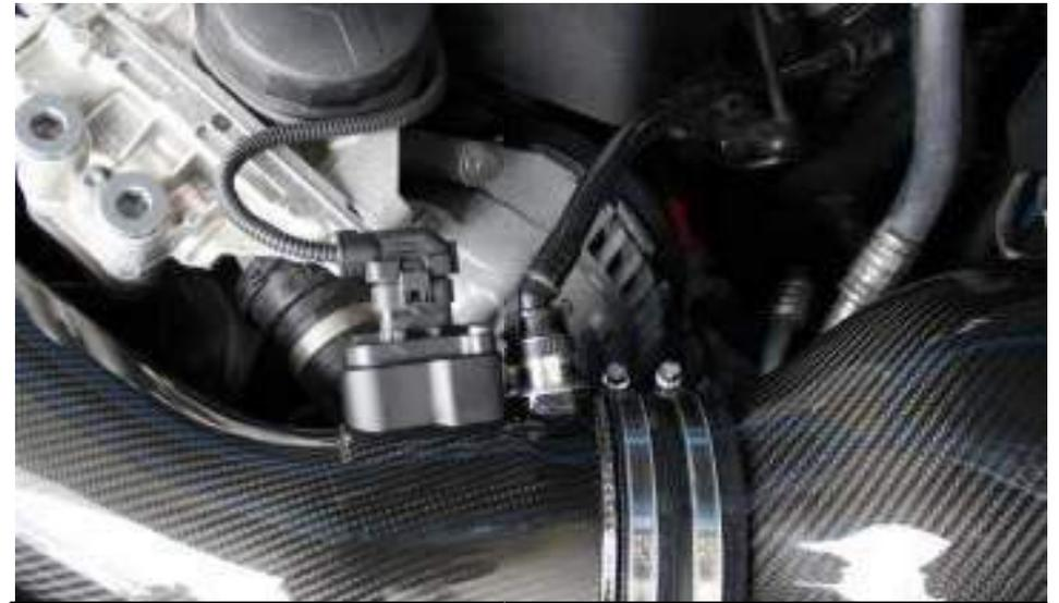
22. Schließen Sie den Luftmassenmesser an und drücken Sie die Belüftung fest. Stellen Sie sicher, dass der LMM eingeklickt ist. Wenn Sie keinen Belüftungsschlauch haben, verwenden Sie den mitgelieferten Silikonstecker, um die Belüftung zu blockieren.
