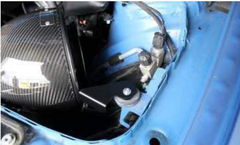
19. Drücken Sie die Befestigung komplett in die Gummidichtung
