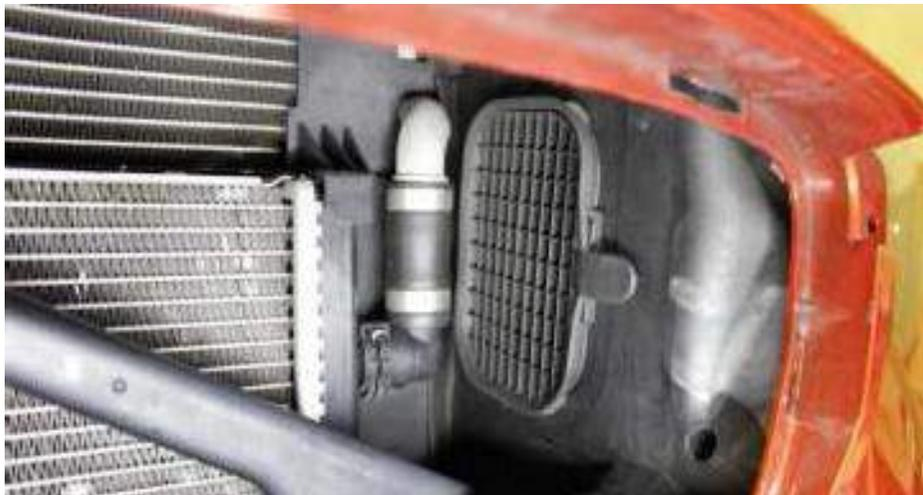
33. Wenn die Grills entfernt sind, sehen Sie dieses innere Gitter, welches entfernt werden muss. Einfach an dem Gummistecker ziehen um das Gitter herauslösen zu können. Siehe nächstes Foto!
