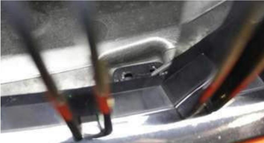
32. Entfernen Sie die Frontgrills. Es gibt 8 Klammern pro Grill (siehe nächstes Foto). Die unteren Klammern müssen nach oben und die oberen Klammern nach unten gedrückt werden. Starten Sie unten, verwenden Sie einen kleinen Schraubenzieher um die Klammern von hinten hochzudrücken. Gleichzeitig ziehen Sie den Grill nach vorne. Wenn die unteren Klammern gelöst sind, lösen Sie die oberen Klammern mit den Fingern.
