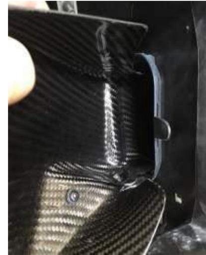
36. Drücken Sie den Scoop herunter, sodass dieser so in der Serienführung liegt wie auf dem Bild. Die Scoop Installation ist nun fertig. Drücken Sie den Grill wieder in die Front.
