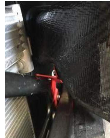
38. Sichern Sie die Klammer an der Strebe mit Hilfe der gelieferten M6x20 Schraube und Unterlegscheibe (siehe Schritt 24). Die Klammer ist hier rot eingefärbt. Drücken Sie den Grill wieder in die Front.
