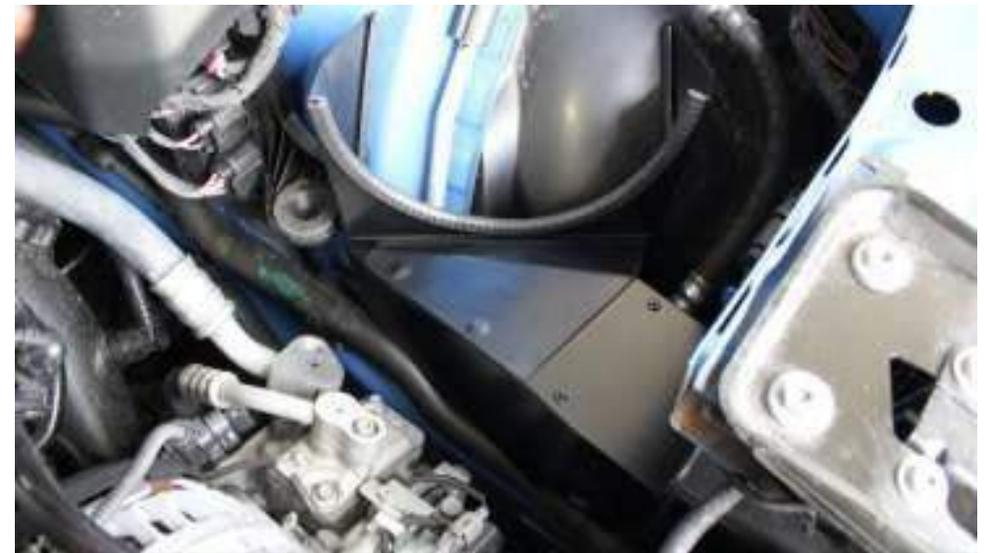
8. Platzieren Sie jetzt die neue Luftführung aus Metall wie auf dem Bild gezeigt – es sollte über die serienmäßigen Lufteinlässe gehen, was im nächsten Schritt detailliert gezeigt wird.
