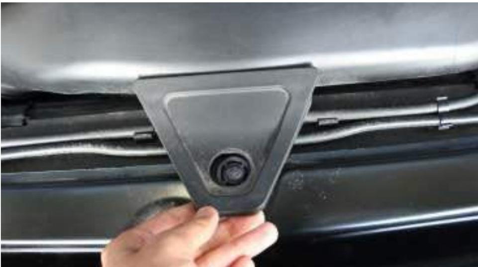
3. Ziehen Sie die Abdeckung nach oben, sodass diese aus der Gummidichtung gelöst wird.
