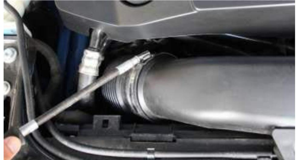
2. Lösen Sie die Klemme, welche das Intake Rohr mit den flexiblen Einlässen verbindet.
