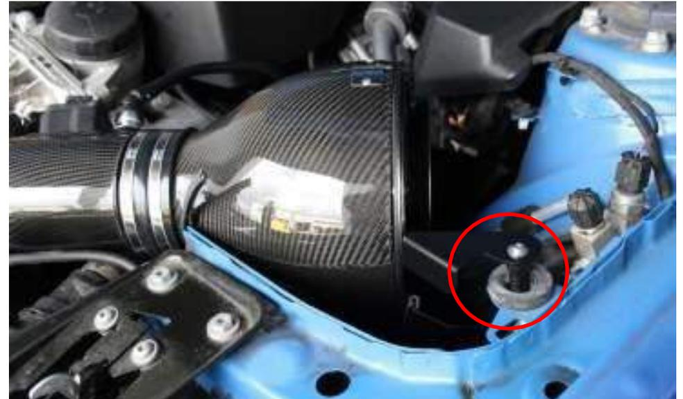
18. Legen Sie das Intake vorsichtig in den Motorraum und positionieren Sie die Befestigung über der Gummidichtung (siehe Bild).
