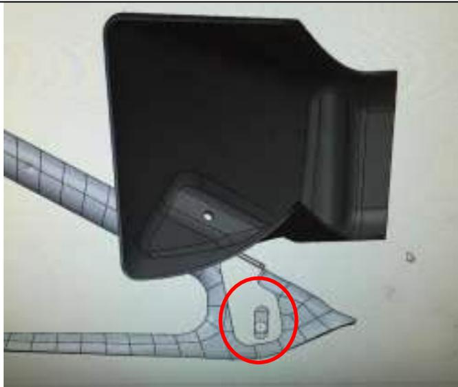
37. Bei dem M2 muss der Scoop so in der Führung liegen wie auf Bild 36. Richten Sie die Klammer mit dem Loch so aus, wie in der CAD Zeichnung auf dem Bild.
