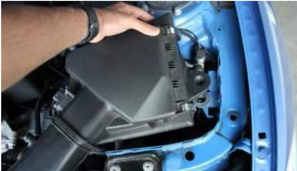
7. Ziehen Sie jetzt die Airbox nach oben aus den Gummidichtungen. Ziehen Sie das Intake Rohr aus dem flexiblen Schlauch, sodass das Gehäuse komplett entfernt wird.
