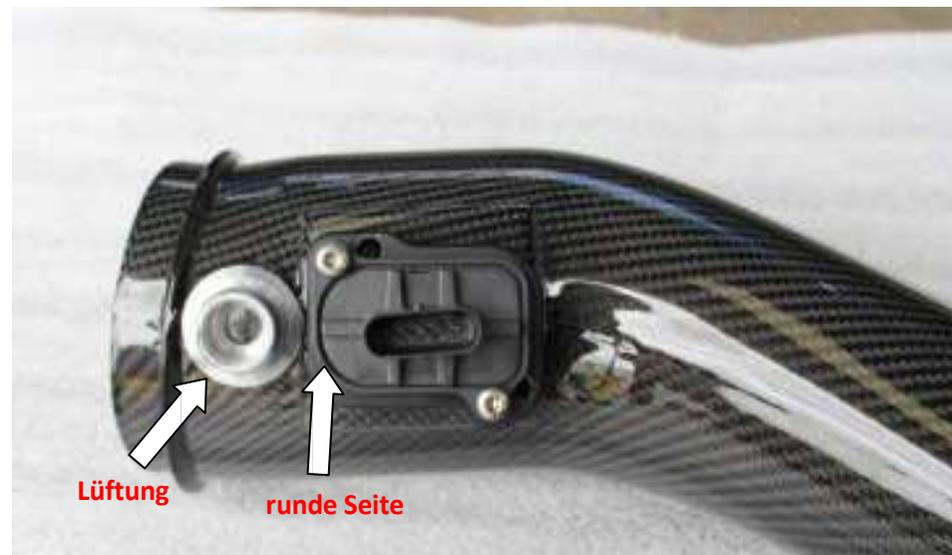
14. Installieren Sie den Sensor am Carbon Rohr. Stellen Sie sicher, dass der Sensor so ausgerichtet ist wie auf dem Bild. Die runde Seite des Sensors soll in Richtung der Lüftung zeigen. Verwenden Sie die 2 mitgelieferten Torx Schrauben.
