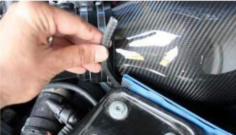
23. Entfernen Sie die Gummikante. Bei dem M2 installieren Sie die Domstrebe nun wieder, welche in Schritt 6 ausgebaut wurde.
