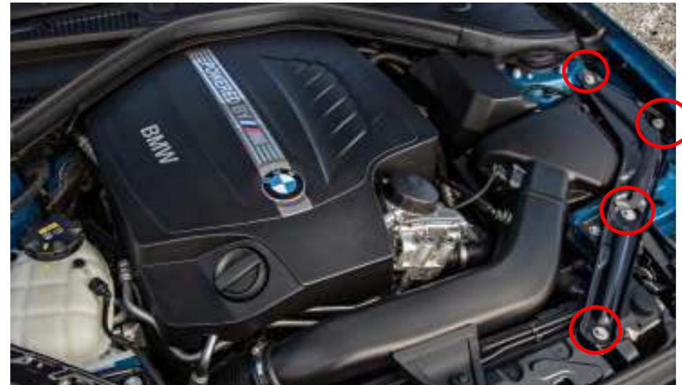
6. Falls Sie das Intake an einem M2 installieren ist es hilfreich, die Domstrebe auf der Seite des Intakes zu entfernen. Entfernen Sie dafür einfach die 4 Schrauben und legen Sie die Domstrebe zur Seite.
