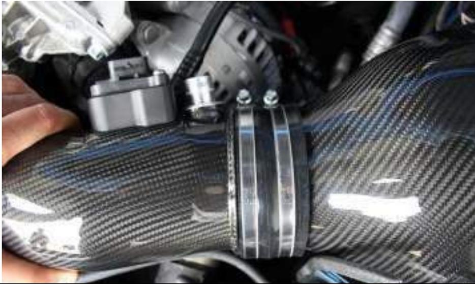
21. Drücken Sie das Rohr und das Gehäuse zusammen, sodass das Silikon komplett über das Rohr geht und gegen den Bund stößt. Ziehen Sie dann die verbleibende Klemme um das Gehäuse fest. Nicht zu fest zuziehen!
