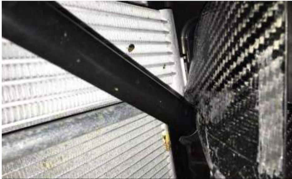
35. Beim M235i / M135i drücken Sie den Klip auf der Rückseite des Scoops auf die Metallstrebe hinter dem Grill.
