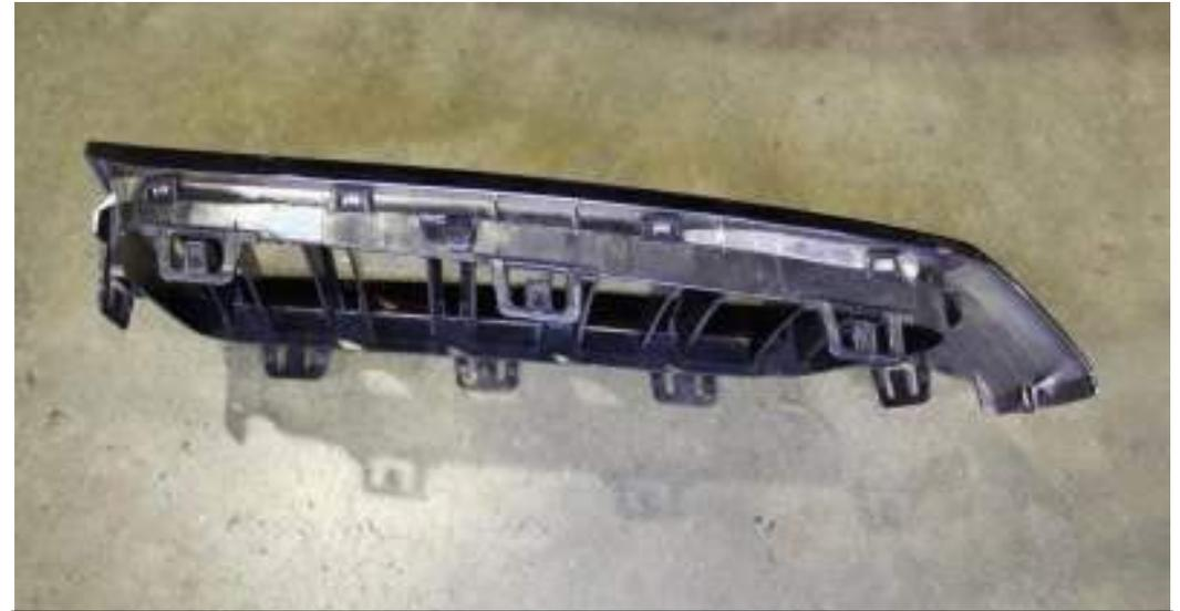
Hier sieht man den entfernten Grill mit den Klammern. Wenn Sie die Klammern nicht entfernt kriegen, müssen Sie die Torx Schrauben lösen, welche oben die Frontschürze befestigen. Diese befinden sich unter der Gummiabdeckung. Dann können Sie von oben in die Front greifen und die Grills lösen.
