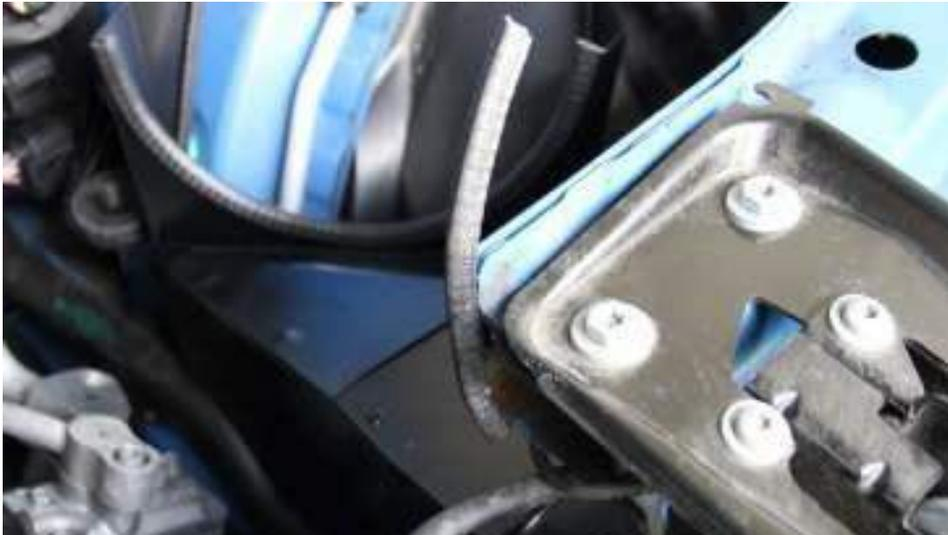
17. Platzieren Sie die mitgelieferte Gummikante über die freistehende Metallkante hinter dem Verschluss der Haube auf der Seite der Luftführung. Dies dient nur dem Schutz vor Kratzern an der Carbon Oberfläche bei der Installation.
