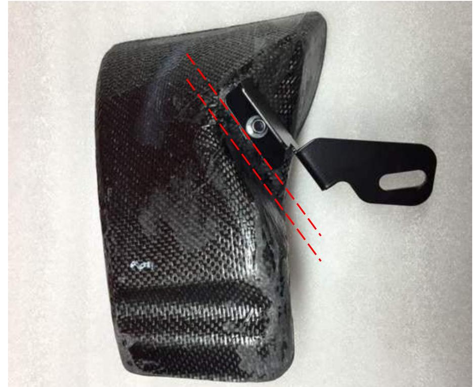
30. Nehmen Sie die Metallhalterung und montieren Sie diese auf der Rückseite des Scoops wie auf dem Bild. Verwenden Sie eine Unterlegscheibe und ziehen Sie fest. Die Ausrichtung sollte wie auf dem Bild sein – die Ecke der Klammer parallel zu der Ecke des Gefälles des Carbons.
