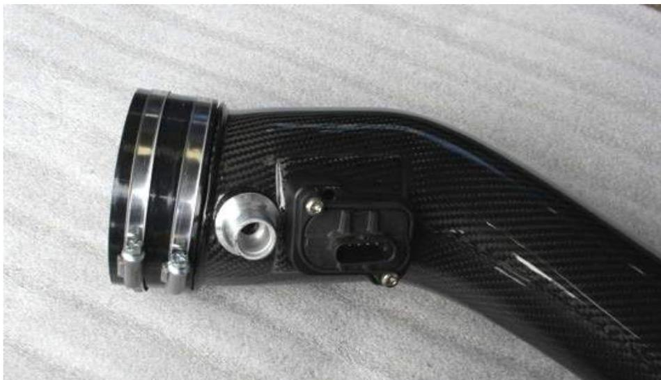
15. Schieben Sie die mitgelieferten Silikonringe über das Carbon Rohr – schieben Sie es bis zum Bund und stellen Sie sicher, dass es komplett sitzt. Ziehen Sie die Klammern noch nicht fest.
