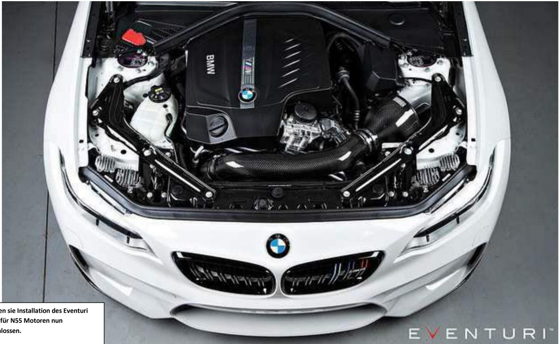
**Sie haben die Installation des Eventuri Intakes für N55 Motoren nun abgeschlossen.**
