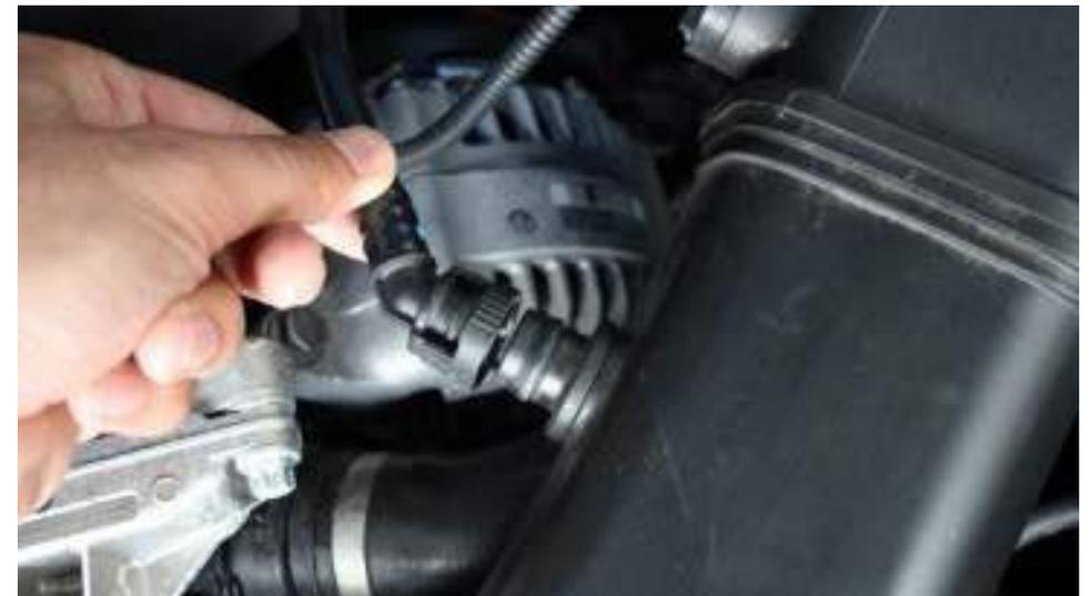
4. Entfernen Sie die Entlüftung vom Intake Rohr. Dies geschieht indem die hinteren Plastikbügel zusammengepresst werden und so von dem Rohr weggezogen werden.
