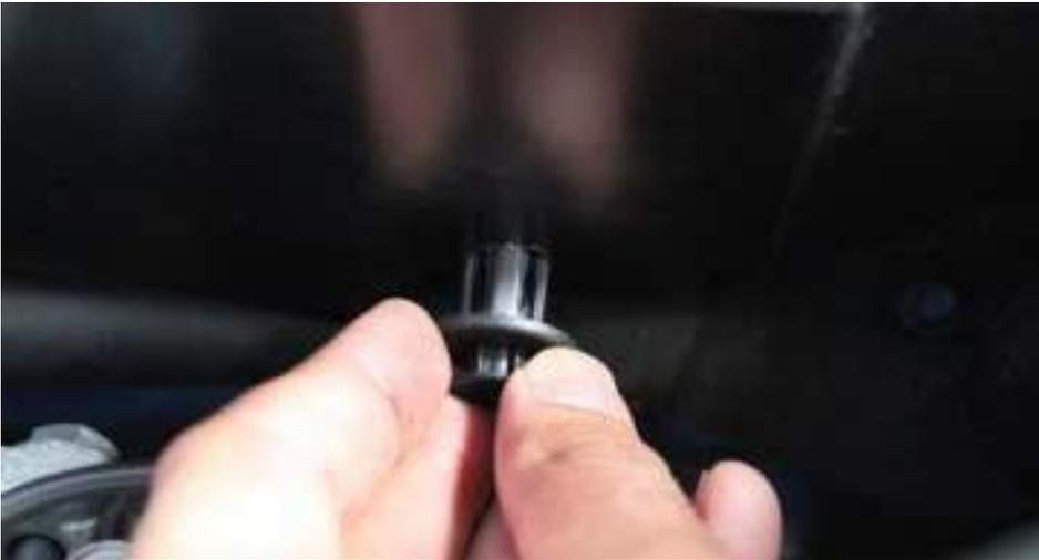
11. Drücken Sie die Niete durch eins der Löcher wie in Schritt 9 beschrieben. Die Niete muss so ausgerichtet sein, dass einer der Haken nach oben zeigt wie im Bild zu sehen ist.
