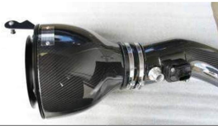
16. Stecken Sie jetzt das Gehäuse an die Silikondichtung. Richten Sie Gehäuse und Rohr so aus wie auf dem Bild. Ziehen Sie die Klammern am Gehäuse fest, lassen Sie die Klammern an dem Rohr jedoch locker. Nicht zu fest zuziehen!
