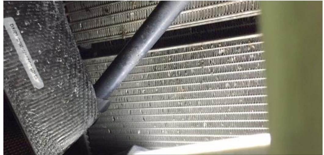
37. Drücken Sie das Leitblech nach hinten bis der Halter in die Strebe einspringt.
