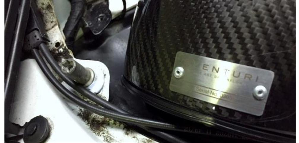
28. Es sollte genügend Freiraum zwischen Luftfiltergehäuse und Karosserie vorhanden sein. Justieren Sie das Gehäuse nach wenn notwendig.
