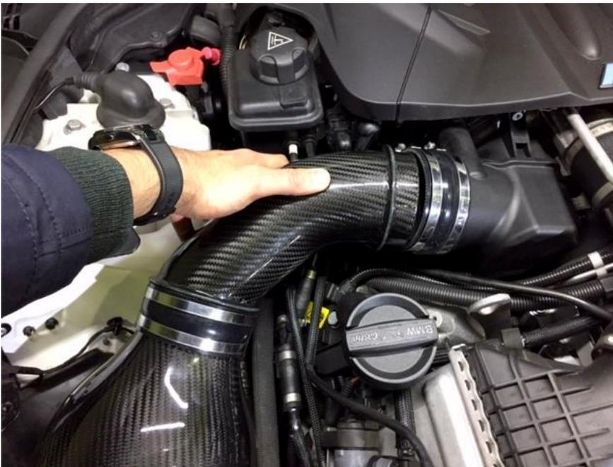
26. Drehen Sie das Ansaugrohr in Richtung Turboeinlass und setzen Sie es ein. Wenn notwendig lösen Sie die Schellen.
