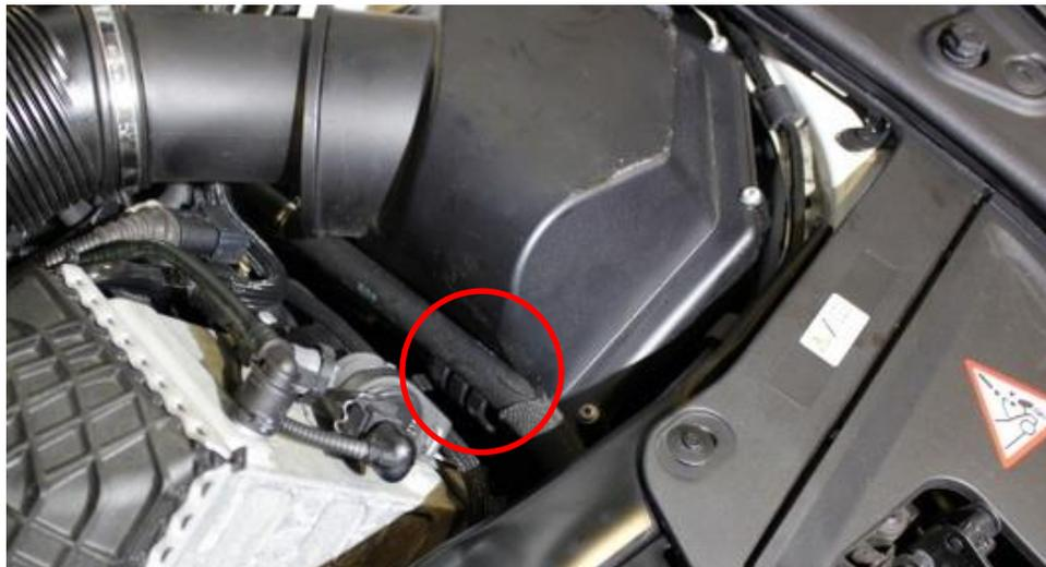
3. Lösen Sie die Leitung vom Gehäuse und legen Sie sie beiseite.
