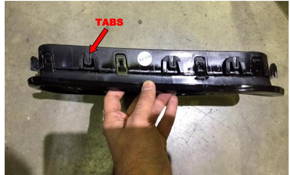
33. Ziehen Sie die Stoßstange vorsichtig nach vorne um mit einem Schraubendreher die Halteklipse des Frontgrills zu lösen. Ziehen Sie den Grill nach vorne raus. Bitte nehmen Sie die Demontage mit Geduld vor.
