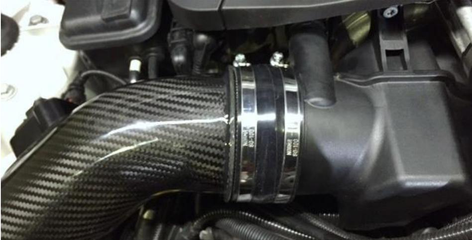
27. Stellen Sie sicher dass das Ansaugrohr bis zum Anschlag im Silikonrohr sitzt, die Carbonflanke muss anliegen.
