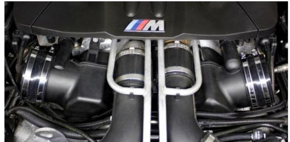
20. Schieben Sie die 83 mm Silikonschläuche über die Turboeinlässe wie auf dem Foto gezeigt. Ziehen Sie die Schellen über die Schläuche, ziehen diese aber noch nicht fest. Achten Sie darauf, dass die Schläuche bis zum Anschlag sitzen.
