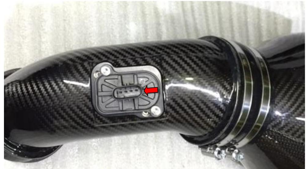
24. Übernehmen Sie die MAF Sensoren aus dem originalen Ansaugrohr, achten Sie auf die korrekte Position des Sensors . Auf dem Sensor ist ein Pfeil der die Flussrichtung vorgibt. Nutzen Sie die mitgelieferten M4 Torx Schrauben.
