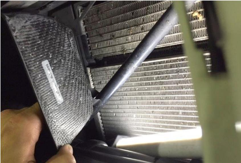
36. Führen Sie das Leitblech in die Stoßstange und positionieren Sie die Halterung an der Strebe.
