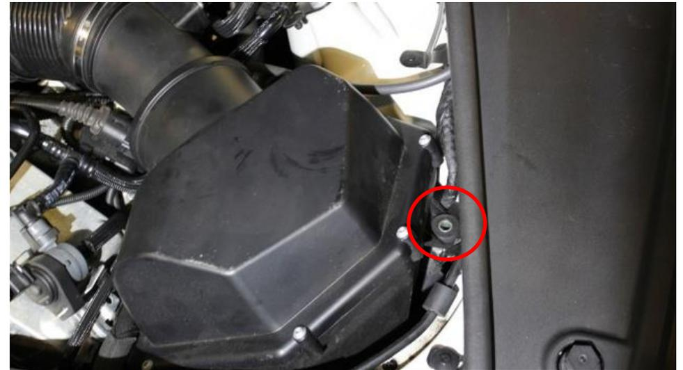
2. Entfernen Sie die Schrauben auf der rechten Seite des Luftfiltergehäuses
