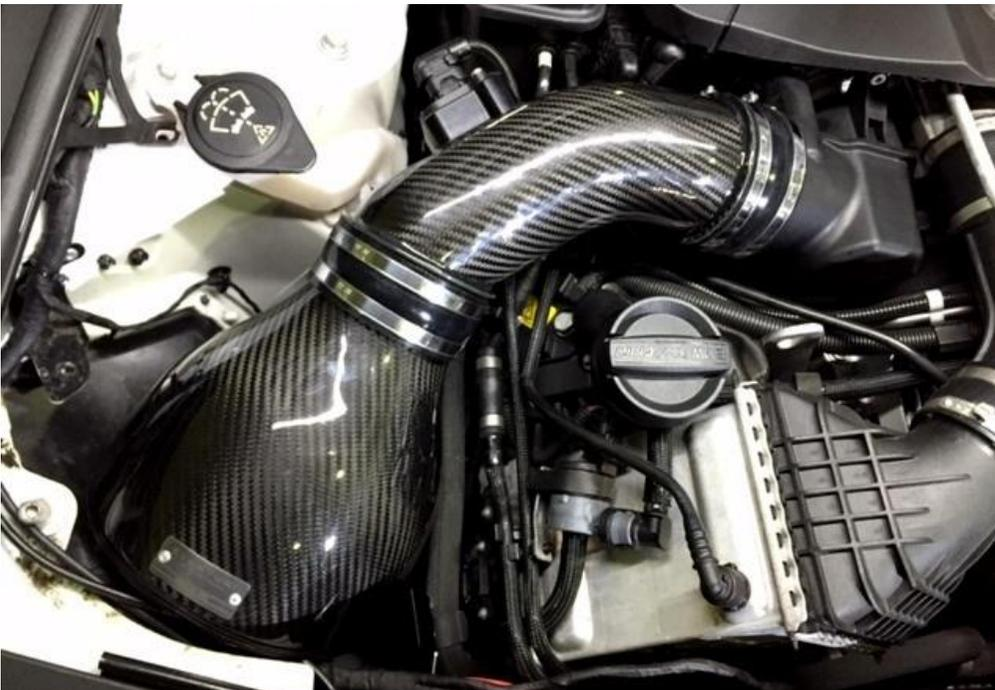
29. Der MAF Sensor liegt auf der Rückseite und zeigt nach unten, wie auf dem Foto gezeigt. Setzen Sie den Stecker wieder ein bis es "klickt". Ziehen Sie alle Schellen an.
