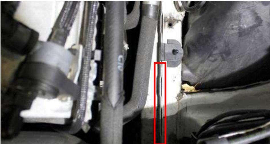
11. Positionieren Sie den Kantenschutz wie auf dem Foto gezeigt.
