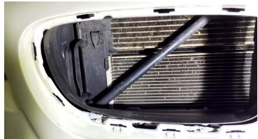
35. Beginnen Sie mit dem linken Blech. Die Halterung wird später an die Strebe gedrückt.
